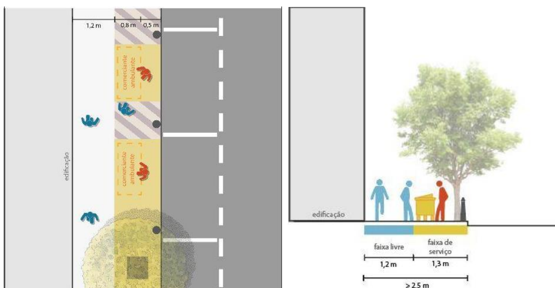
Figura 62 - Instalação da atividade comercial transitória em calçadas com mais de 2,5 m de largura.
