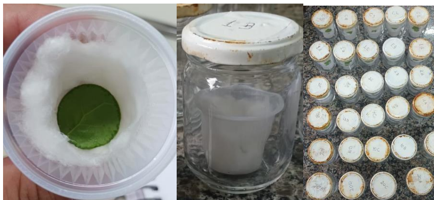
Figura 12: Câmara de fumigação para teste de toxicidade em T. urticae . FONTE: Autor
