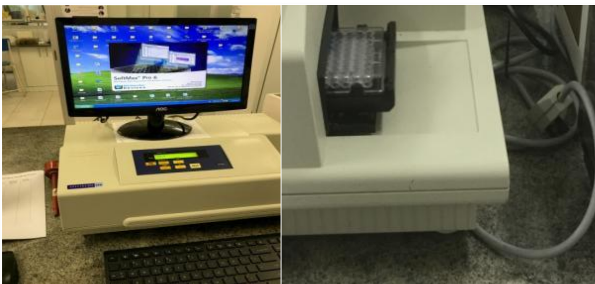
Figura 2. Etapas da leitura de microplaca contendo amostras de plasma para verificação de AOPP.
