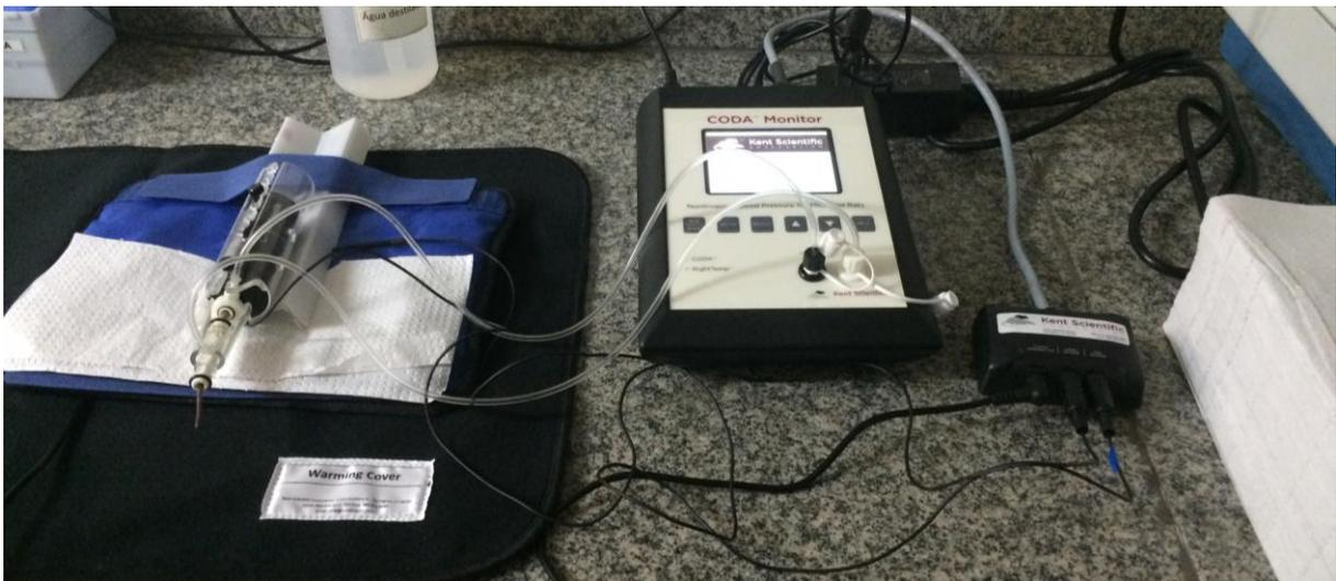
**Figura 1.** Pletismógrafo de cauda (CODA Mouse Tail-Cuff Blood Pressure System, KENT Scientific CO., Connecticut, USA). Fotos da própria autora.
