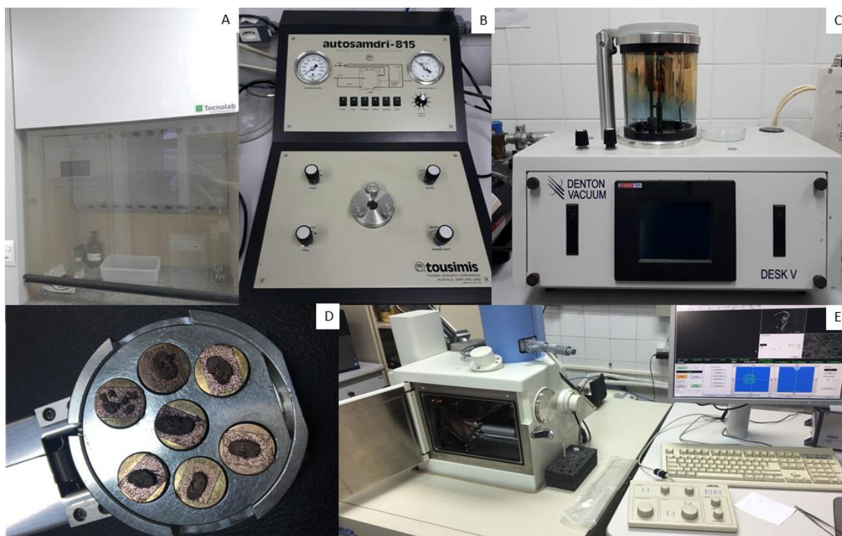
Figura 4. Etapas da microscopia eletrônica de varredura. A) Capela onde as amostras são preparadas, B) Secagem das amostras em ponto crítico com CO 2 C) Metalização das amostras com ouro D) Rins já metalizados dispostos para serem analisados E) Microscópio eletrônico de varredura no qual as amostras são inseridas, à direita, interface no computador. Fotos da própria autora.
