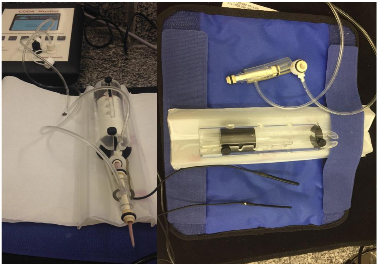
Figura 2. Pletismógrafo de cauda (CODA Mouse Tail-Cuff Blood Pressure System, KENT Scientific CO., Connecticut, USA). Fotos da própria autora.
