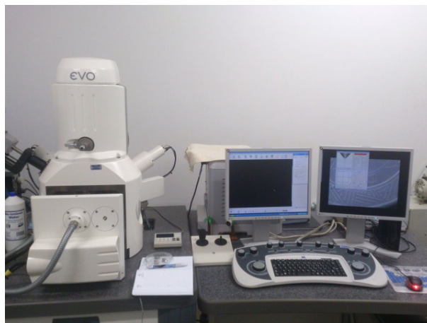
Figura 9: Microscópio Eletrônico de Varredura ZEISS EVO 40. Fonte: Arquivo pessoal.
