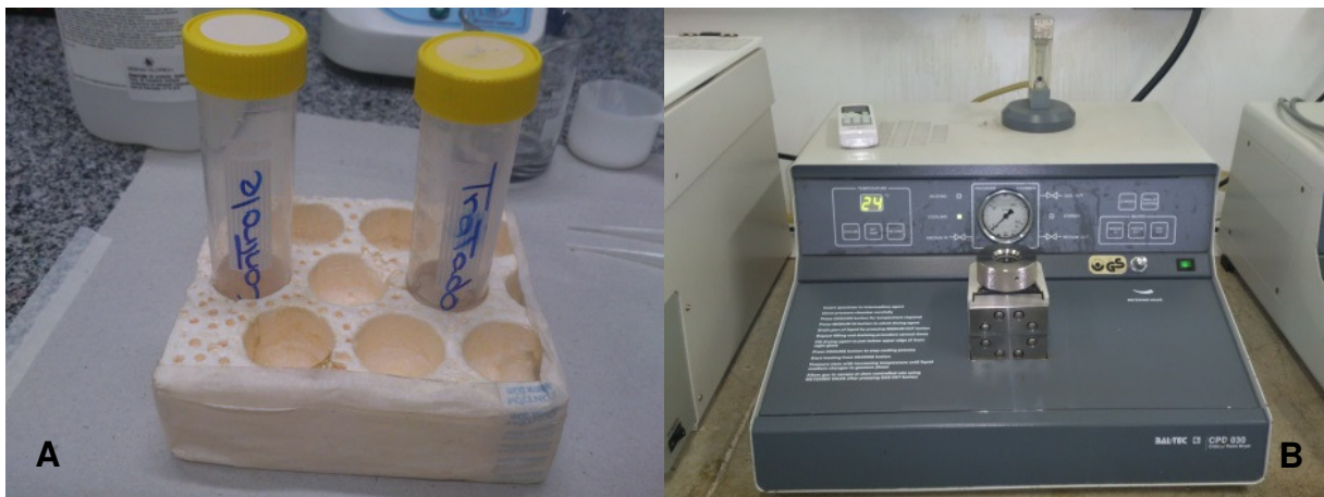
Figura 7: A: Processo de desidratação com acetona. B: Equipamento para submissão dos dentes ao ponto crítico. Fonte: Arquivo pessoal.
