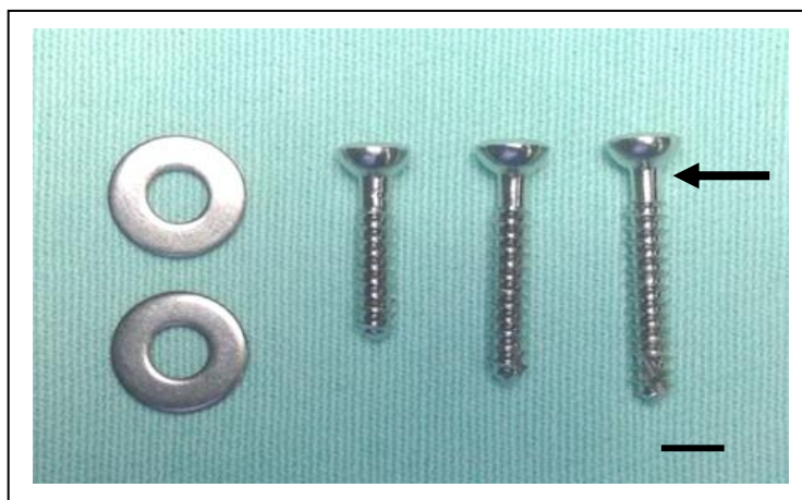
Figura 5: Imagem fotográfica ilustrando os parafusos utilizados, ressaltando a rosca 3 mm abaixo da cabeça e as arruelas (seta), ambos de aço inoxidável. (escala = 5 mm).
