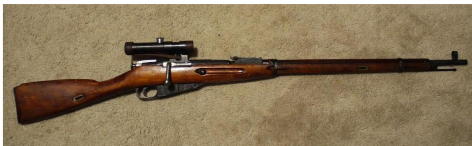
**Figura 24.** Fuzil Mosin-Nagant, modelo M91/30, calibre 7,62 X 54mm, com mira telescópica com magnificação de quatro vezes.
