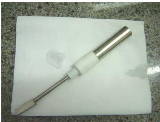
Figura 1 – Barra de metal com área de  $3,8\text{cm}^2$  e peso de 200 g.
