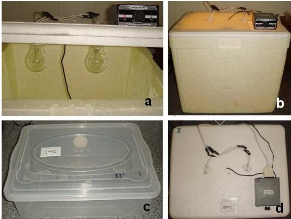
Figura 3 – Incubadoras utilizadas para a determinação da temperatura pivotal. a) Detalhe interno da tampa com as lâmpadas e o termostato. b) Aspecto geral da incubadora. c) Recipiente plástico utilizado para a incubação dos ovos. d) Vista da parte superior da incubadora.
