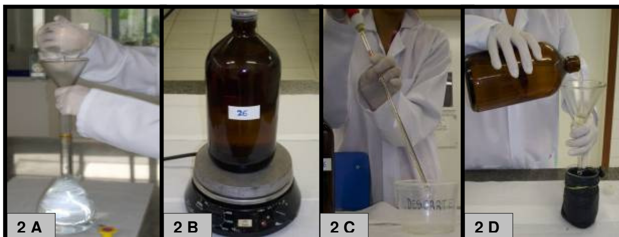
Figura 2. Preparação da fração solúvel do óleo diesel (FSOD). (A) Adição de água em balão volumétrico contendo 5g de óleo diesel até completar o volume de 1L. (B) Homogeneização da mistura (água + óleo diesel) em agitador magnético, por 24h. (C) Descarte do óleo diesel com auxílio de pipeta. (D) Separação da FSOD para uso imediato. Observação: nova fração solúvel de óleo diesel (FSOD) a cada experimento, tanto para cavalo-marinho, Hippocampus reidi , quanto para curimatã, Prochilodus vimboides .
