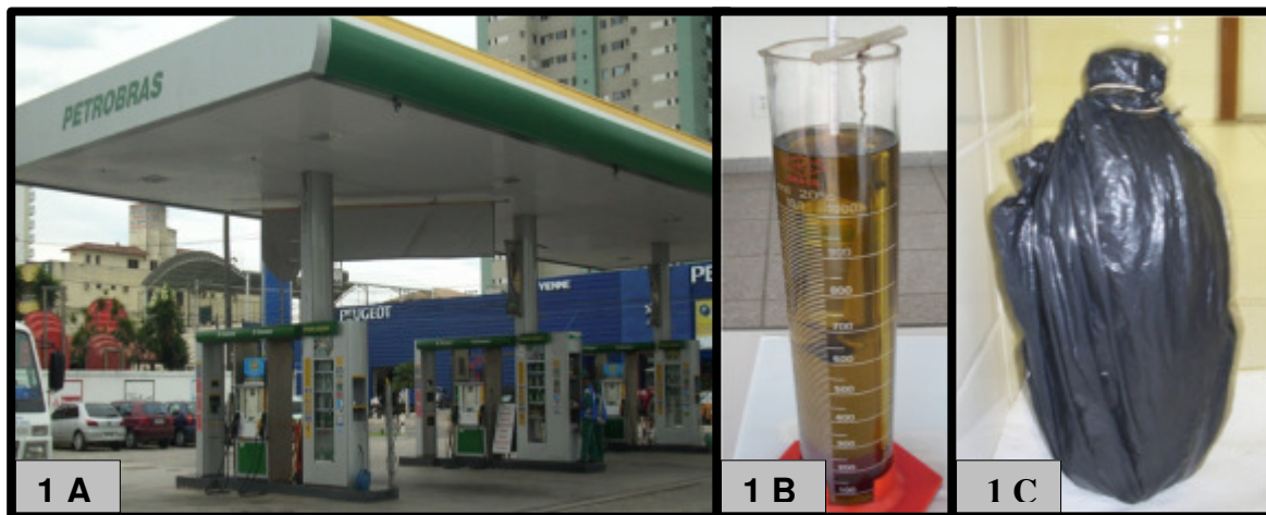
Figura 1. Aquisição do óleo diesel comercial. (A) Posto de combustível, bandeira-branca, do qual o óleo diesel foi adquirido. (B) Material usado no teste de densidade do óleo diesel a fim de certificar a qualidade da substância. (C) Armazenamento do óleo diesel em recipiente coberto por saco plástico preto a fim de manter estáveis propriedades físico-químicas do óleo. Observação: novo óleo diesel a cada experimento, tanto para cavalo-marinho, Hippocampus reidi , quanto para curimatã Prochilodus vimboides .
