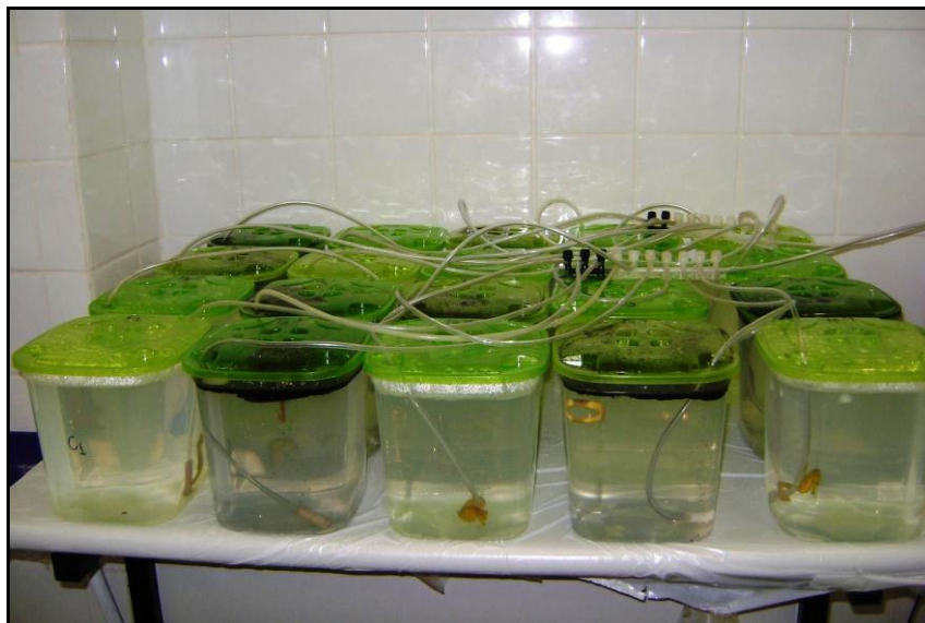
Figura 2. Aquários testes com capacidade de 3L nos quais os exemplares de Hippocampus reidi foram expostos ao petróleo ( 10\text{mL.L}^{-1} ) acompanhados do grupo controle ( n=8 ).
