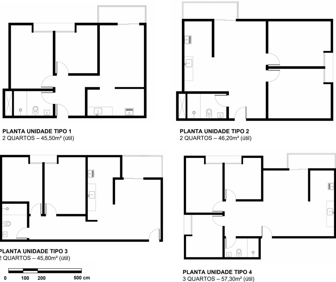
Figura 25 – Diversidade tipológica em número de quartos e áreas - menção honrosa 900 do edital 008/2016
