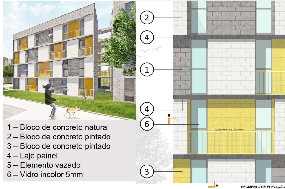
Figura 20 – Sistema construtivo proposto pelo primeiro colocado do edital 006/2016.
