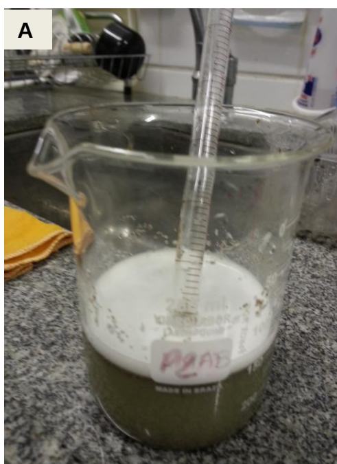
Figura 2.2 Massa de ovos dissociada no Becker (A) com posterior retirada de alíquota (2 ml) e disposta em Placa de Petri para a contagem (B).
