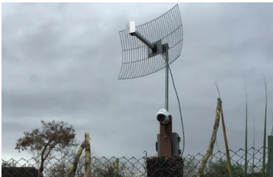
Figura 1 Câmera de monitoramento remoto e antena de transmissão de sinal sem fio, instalada no brete de ceva, viabilizando o fechamento remoto da porta, no momento da captura.
