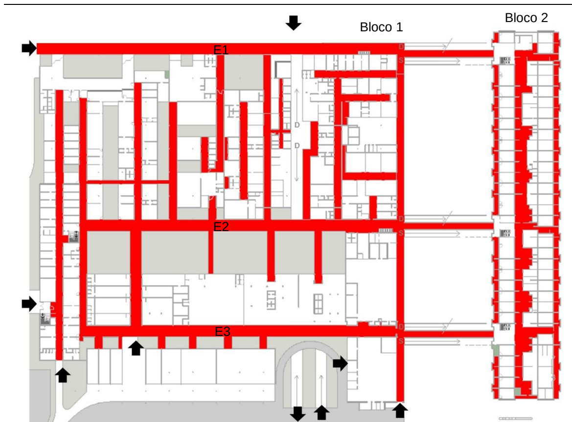
Figura 82: Elementos de circulação horizontal HGG
