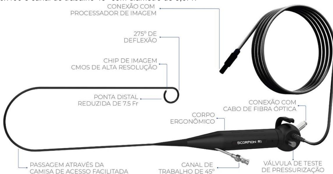
Figura 8 - Ureterorenoscópio digital Scorpion R1 com haste deflexão 275°, resolução de imagem 400x400 e canal de trabalho 45° com diâmetro de 3,6Fr.
