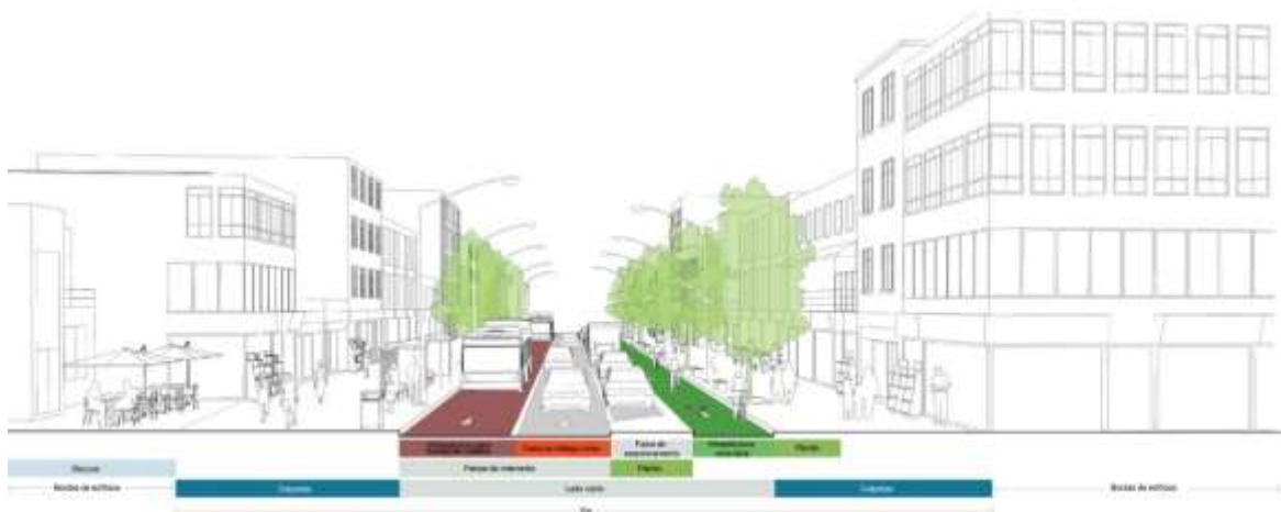
Figura 12: Elementos do sistema viário
